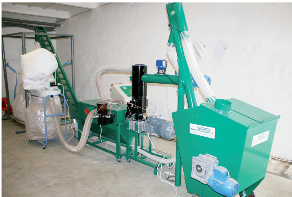
Peletizačná linka MGL dokáže vyrobiť až 150 kg peliet za hodinu.
